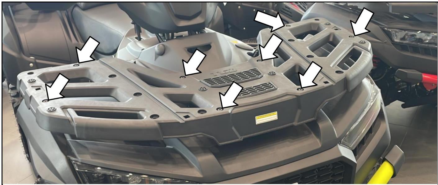
Снимите передний багажник, открутив указанные винты.
