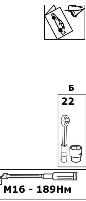
**5** Закрепить шар с помощью крепежных элементов, как указано на схеме.
