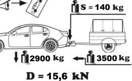
bei zulässigem Gesamtgewicht des Fahrzeuges nakománnyal terhelt járműsúly esetén. pour poids total en charge autorisé du véhicule per un peso complessivo ammesso del veicolo bij toelaatbaar totaal gewicht van het voertuig con peso total autorizado del vehiculo ajoneuvon suurimmalla sallitulla kokonaispainolla S vid fordonets tillİtna totalvikt N ved kjøretøyets tillatte totalvekt při celkové přípustné hmotnosti vozidla
